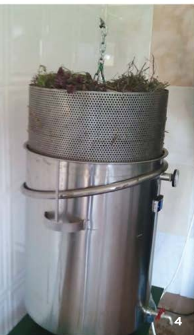
Figura 4 . Após escolha e corte, abastecimento dos destiladores para destilação por arrastamento de vapor. Figura 5 . Destilador em aço inoxidável embutido, com os distintos componentes: dorna principal com o material vegetal e serpentina, um condensador multitubular compacto imerso em depósito de água fria. Figura 6 . Aspeto do líquido obtido da destilação por arrastamento de vapor, com a distinta separação das partes: hidrolato e óleo essencial.
