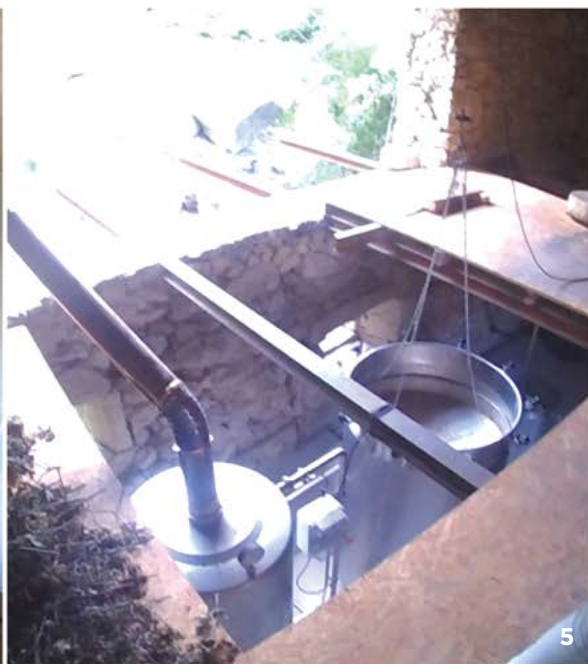
Figura 4 . Após escolha e corte, abastecimento dos destiladores para destilação por arrastamento de vapor. Figura 5 . Destilador em aço inoxidável embutido, com os distintos componentes: dorna principal com o material vegetal e serpentina, um condensador multitubular compacto imerso em depósito de água fria. Figura 6 . Aspeto do líquido obtido da destilação por arrastamento de vapor, com a distinta separação das partes: hidrolato e óleo essencial.
