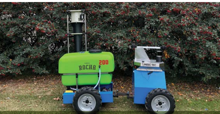
Robot para vinhas de montanha com capacidade de realizar autonomamente tratamentos de baixo débito, 100 litros por hectare. Resulta de parceria entre a Pulverizadores Rocha, SA e o Inesc Tec.
