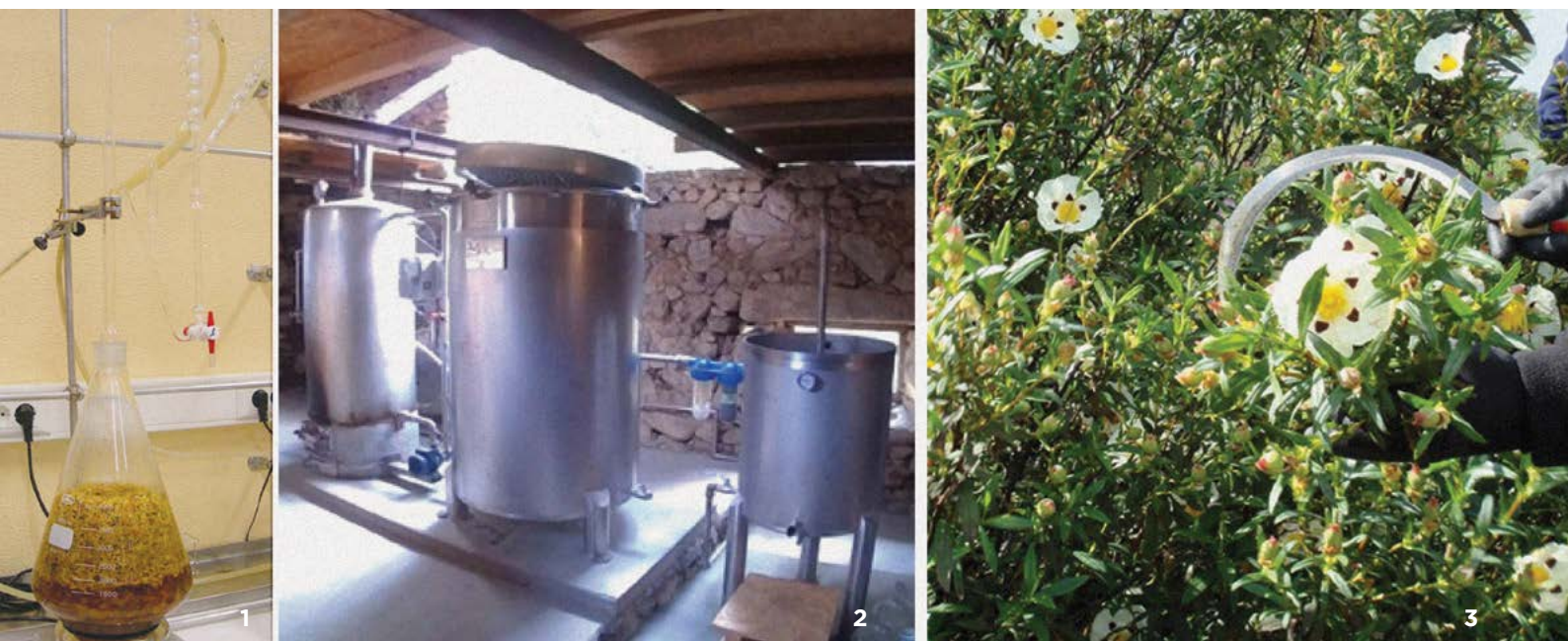
Figura 1. Hidrodestilação laboratorial em aparelho modificado de Clevenger (IPCB/ESA)
