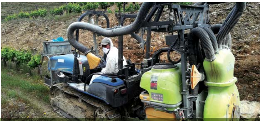
Mittos DOURO, quando equipado com computador de aplicação, permite importar mapas de prescrição e ajustar a aplicação de produto de acordo com a necessidade (taxa variável - VRA).
