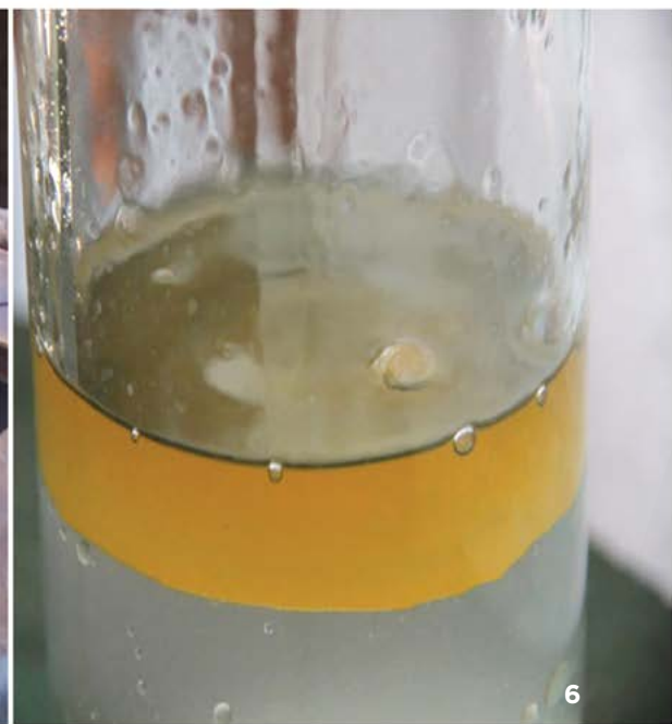
Figura 4 . Após escolha e corte, abastecimento dos destiladores para destilação por arrastamento de vapor. Figura 5 . Destilador em aço inoxidável embutido, com os distintos componentes: dorna principal com o material vegetal e serpentina, um condensador multitubular compacto imerso em depósito de água fria. Figura 6 . Aspeto do líquido obtido da destilação por arrastamento de vapor, com a distinta separação das partes: hidrolato e óleo essencial.
