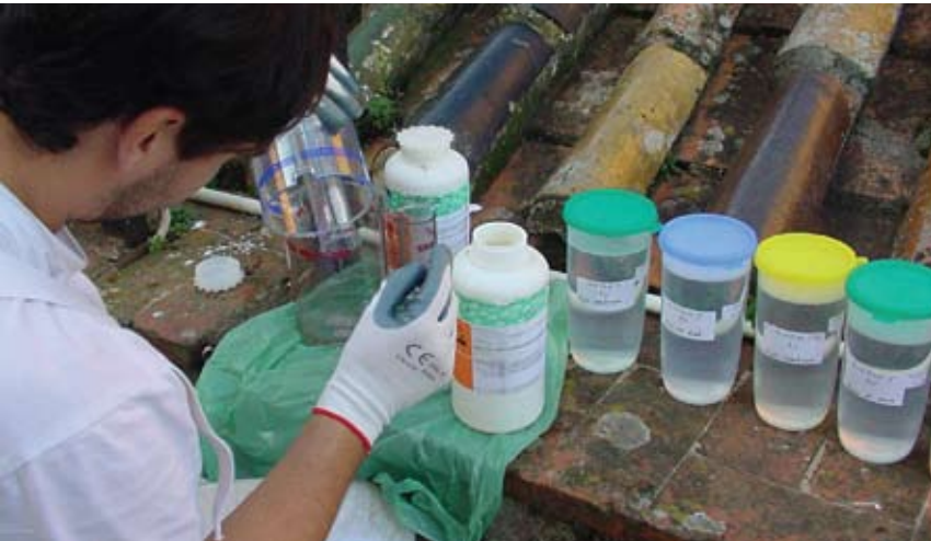
☑ Preparação das soluções com os produtos biocidas para os ensaios de eliminação da colonização biológica, GCU, 2007 Preparation of solutions with biocide products for tests of biological colonisation elimination, GCU, 2007
