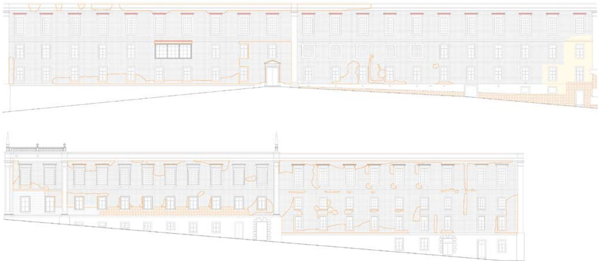
Alçados poente e norte: levantamento da constituição dos revestimentos em reboco, de áreas de degradação do reboco e existência de barramentos de cal ao nível das cornijas, assim como áreas em que o suporte em alvenaria está exposto West and north façades: survey of the composition of stucco coverings, deteriorated stucco areas, lime covering in cornices and areas where the masonry is bare
