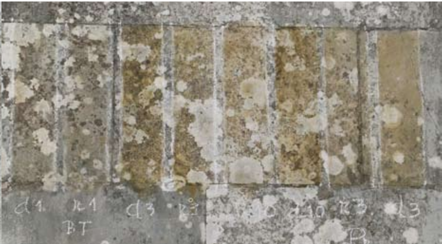
☒ Segunda fase, testes de limpeza: selecção de biocidas, GCU, 2007 Second phase: cleaning tests – selection of biocides, GCU, 2007
