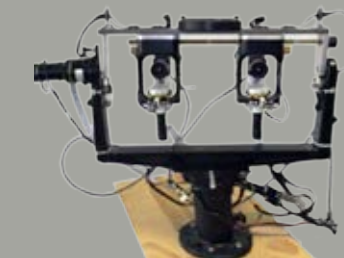
4- Sistema de visão artificial em que a posição e orientação relativas das câmaras podem ser modificadas.
