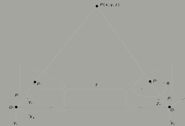
3a- Geometria da configuração estereo.
