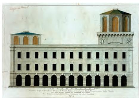
Não propriamente um projecto para o Observatório, pois este continha um programa complexo, mas um exercício demonstrativo da viabilidade de adaptação da torre-cisterna do castelo medieval, de planta quadrangular, a Observatório, “segundo a forma do Observatório na Universidade de Cambridge”.
